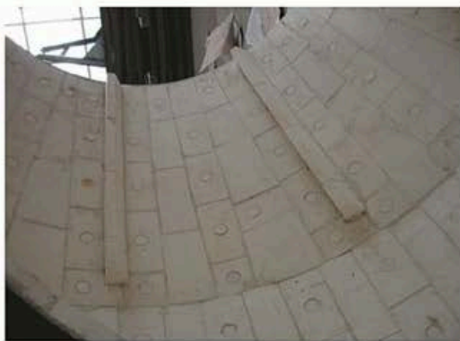
Weldable Tile Lining the Big Pipe Revestimiento de tuberías soldables azulejo grande
